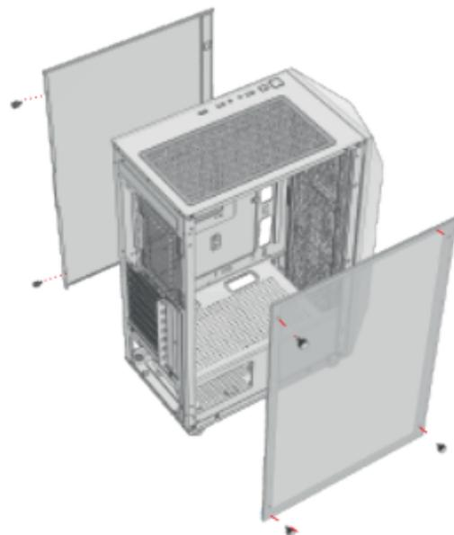
Para remover el panel de cristal templado desatornille los 4 tornillos en cada esquina, como se muestra arriba.
